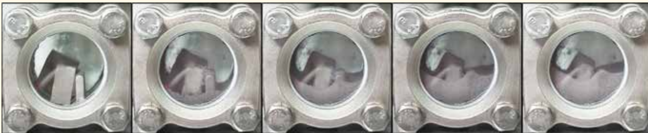
Recycling in Wasserstoffatmosphäre: Der neodymhaltige Magnet zerfällt zu Pulver, was wieder eingesetzt werden kann.
