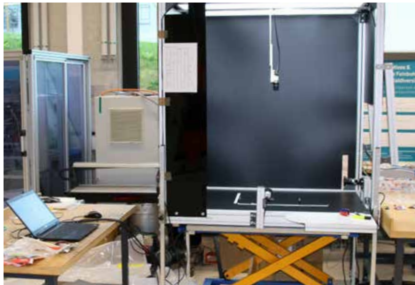
Im ersten Schritt werden die Wissenschaftssäcke geöffnet ( Abbildung links ). Dann bekommen die einzelnen Objekte eine eindeutige ID zugeordnet, werden gewogen und in der Fotobox aus drei verschiedenen Perspektiven fotografiert ( Abbildung rechts ).
