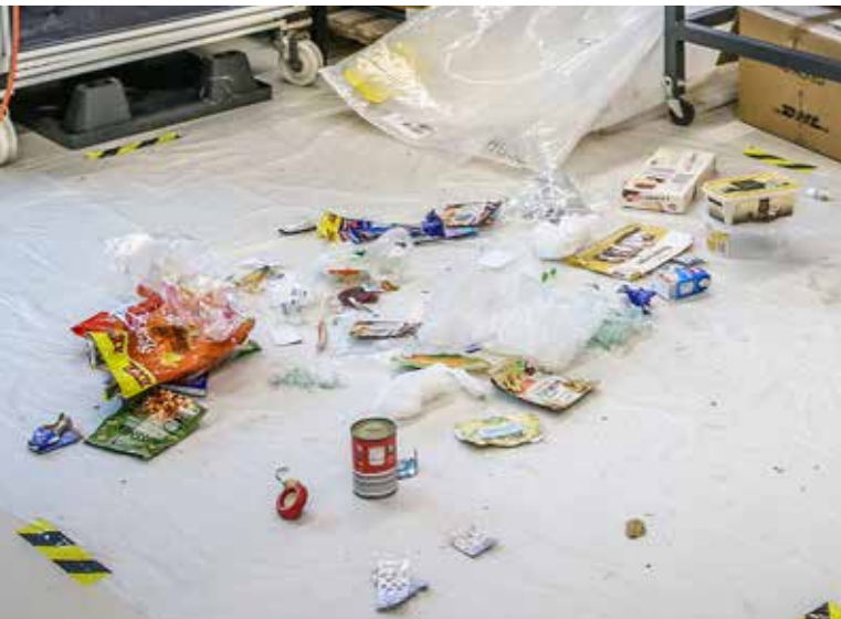
Im ersten Schritt werden die Wissenschaftssäcke geöffnet ( Abbildung links ). Dann bekommen die einzelnen Objekte eine eindeutige ID zugeordnet, werden gewogen und in der Fotobox aus drei verschiedenen Perspektiven fotografiert ( Abbildung rechts ).
