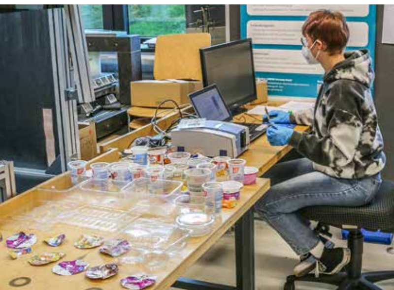
Mithilfe der Nahinfrarotspektroskopie kann die Kunststoffart der Objekte bestimmt werden ( Abbildung links ). Schließlich erfolgt die Tiefencharakterisierung: Eine Detail-Analyse der Objekte anhand von 26 Kriterien ( Abbildung rechts ). Alle Fotos: Simon Eberle
